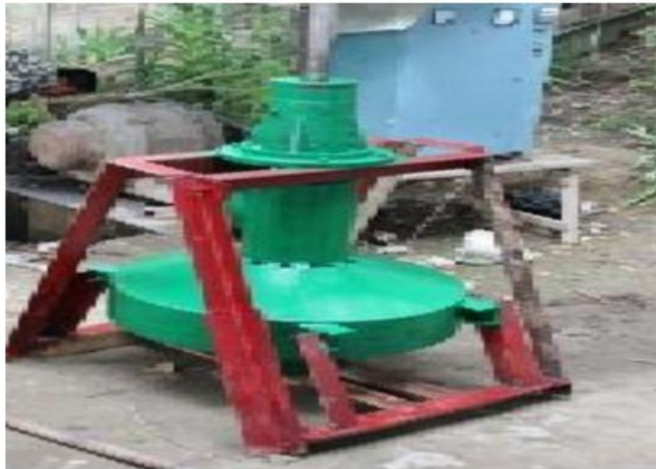
Рис. 2. Изготовленная реактивная гидравлическая турбина для микро ГЭС
