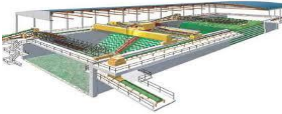
Figura 3 Depozit cu dispunere complexă în formă de cupă de excavator
