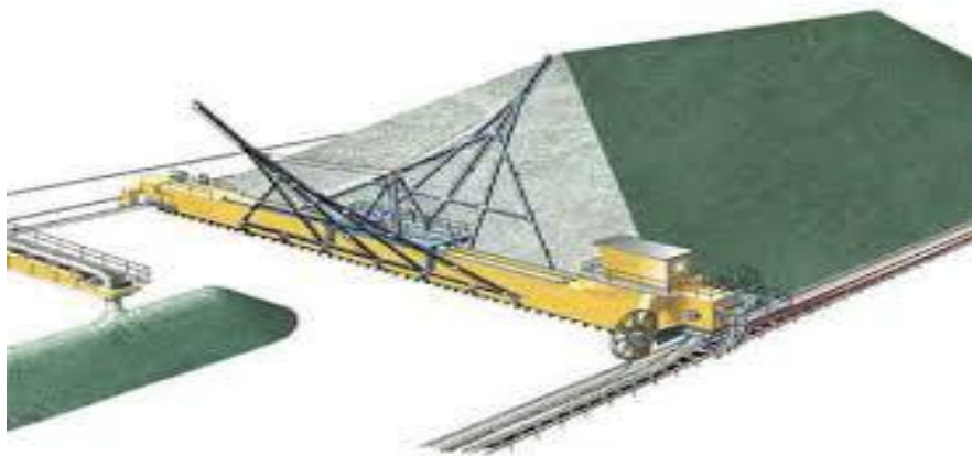
Figura 2 Depozit cu dispunere longitudinală longitudinală cu raclete
