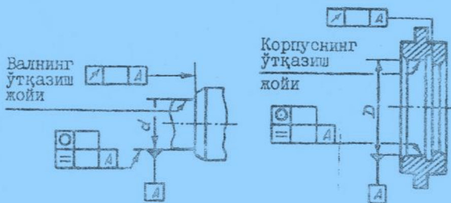
45- расм. Корпус тешиги, вал бўйинларини шакл бўйича жоизликларини ҳамда туташувчи ва таянч ён юзлари жойлашишининг белгиланиши.
