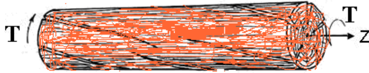
12-rasm. Doiraviy kesimli yog'ochning buralish deformatsiyasidagi buzilishi.
