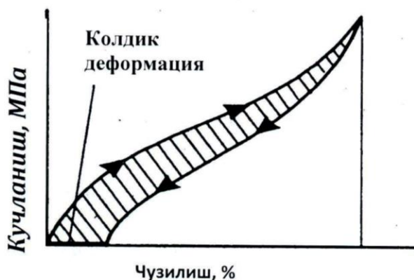
Rasm Berilgan tezlikda rezina deformatsiyasining diagrammasi cho'zish – qayta tiklanish tsiklida
