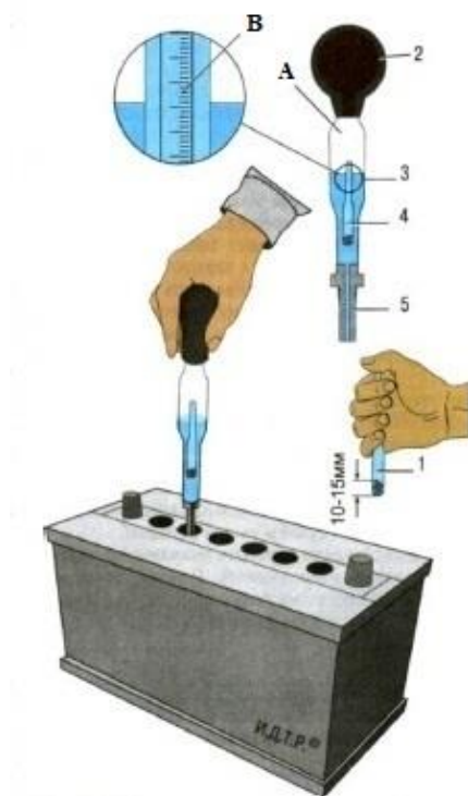
79-Rasm. Elektrolit miqdori va zichligini tekshirish.
