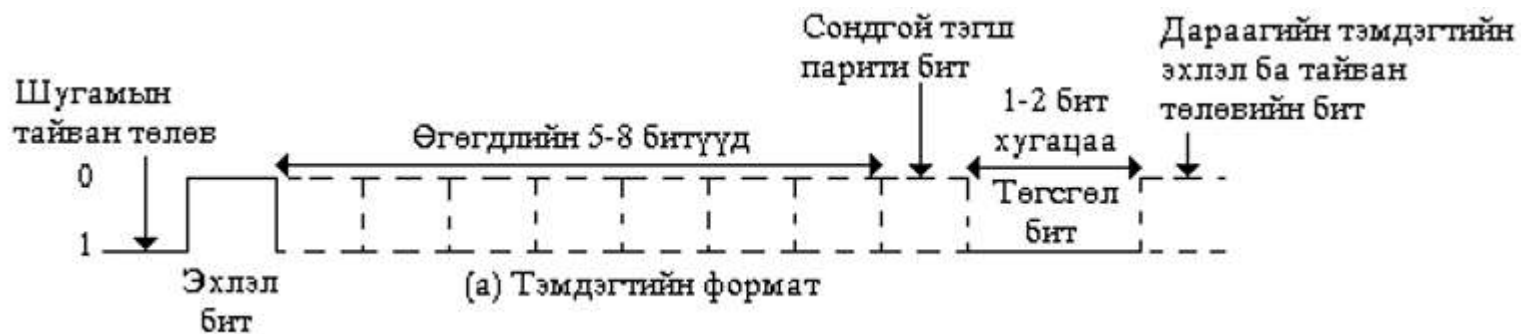
Зураг 3. Компьютерийн ASCII кодоор дамжуулах зарчим
