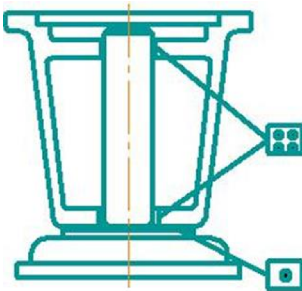
2.6-rasm. Asosiy baza (teshik) va sirt bo‘yicha baland barmoq bilan bazalashtirish.
