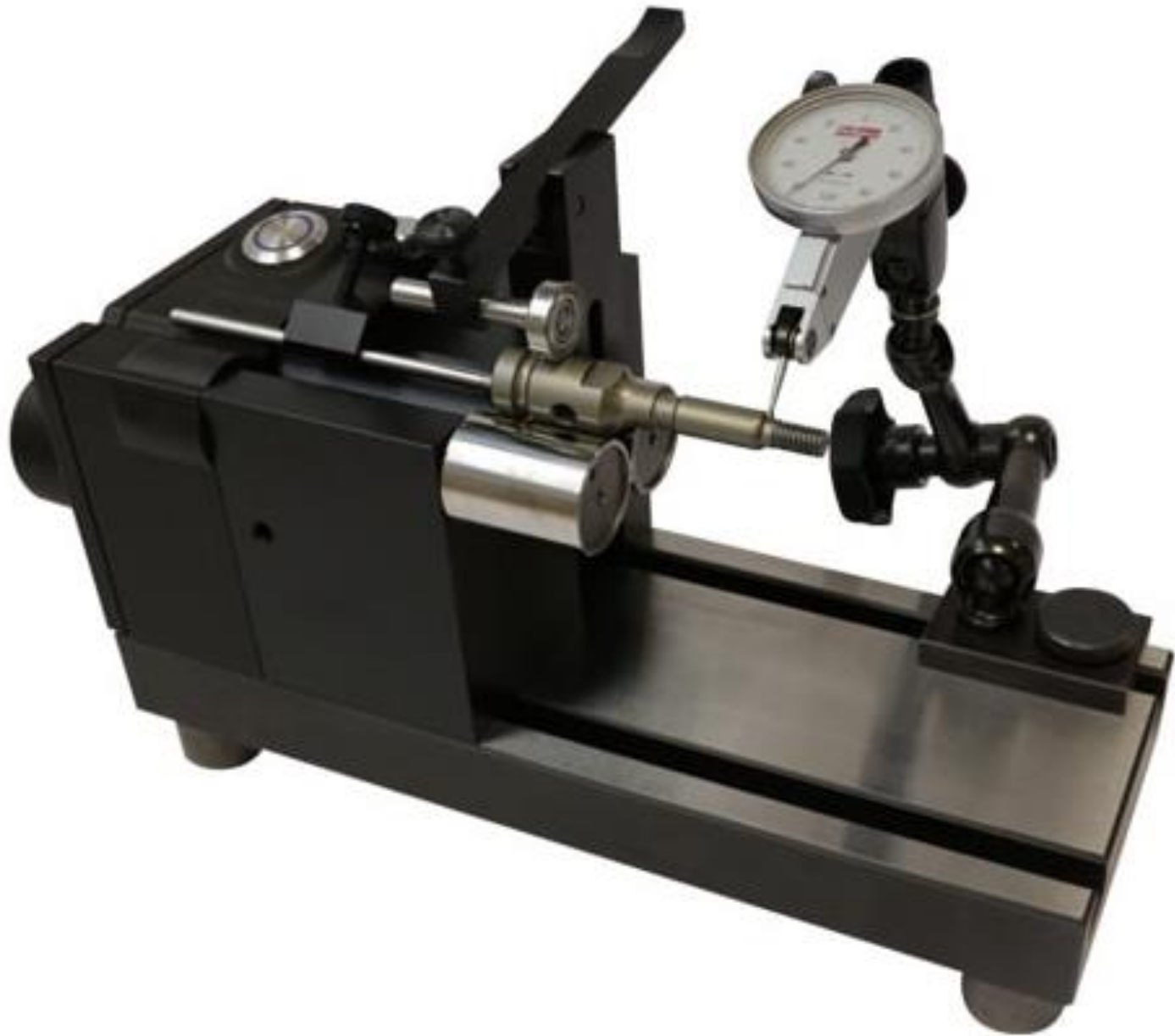
6-rasm. Tashqi silindrik yuzalarni radial urilishini nazorat qilish
