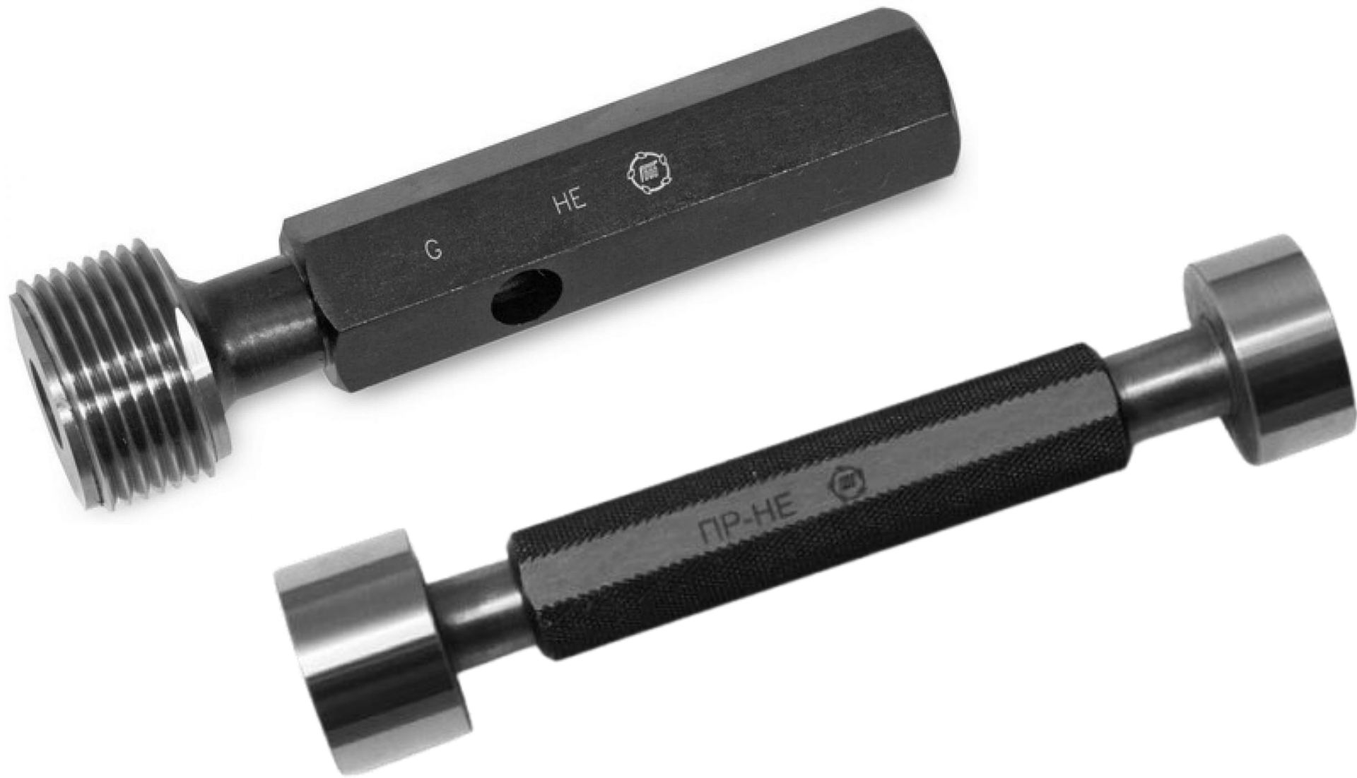
9-rasm. Rezbalarni va silliq yuzali teshiklarni o'lcham aniqligini nazorat qilish uchun asboblari (kalibr).
