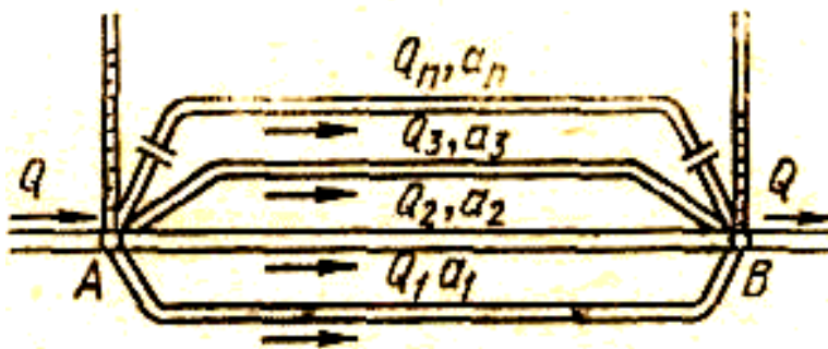
8.6-rasm. Quvurlarni paralel ulash.
